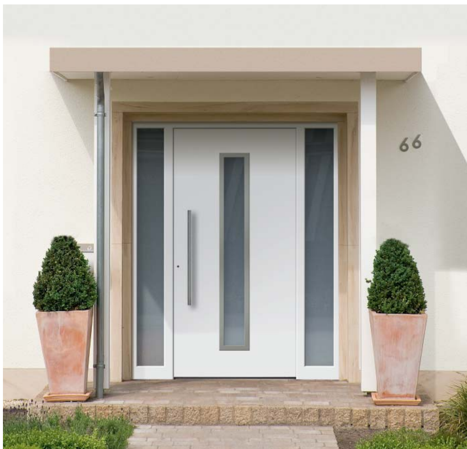
Modell HT40-50 | Farbe: RAL 7016 anthrazitgrau | Glas: G 500-25 mattiertes Glas mit klarem Rand | Aufsatzfüllung | Mit 1600 mm Edelstahl-Stangengriff
