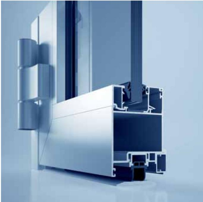
Vielseitige Kombinationsmöglichkeit für den Rauchschutz im Innenbereich: Mit dem Profilsystem heroal D 65 C SP lassen sich nach DIN 18095 RS 1/RS 2 und EN 1634-3 geprüfte 1- und 2-flügelige Rauchschutztüren realisieren – wahlweise auch mit mittiger Verglasung, sowie Rauchschutztüren mit Automatikdrehtürantrieb.
